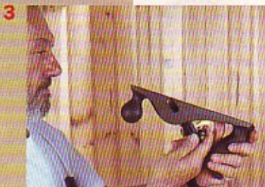
3. La lame doit sortir de 2 à 5 dixièmes de millimètre, en restant parallèle à la semelle de l'outil. Contrôler le réglage à l'œil...
