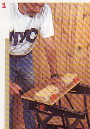
1. La pièce de bois à raboter doit être parfaitement fixe.
