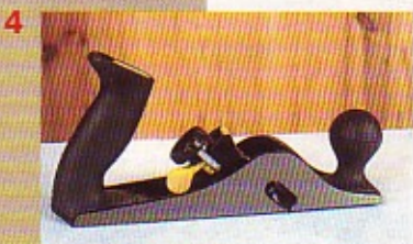
4. ... ou en posant le rabot sur une surface parfaitement plane, par exemple un panneau stratifié.
